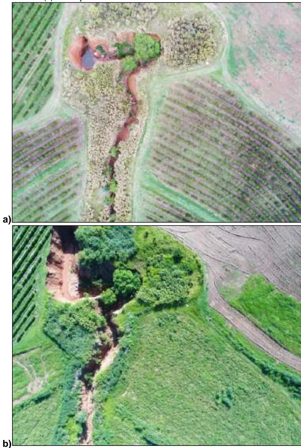
Figura 176 – Vista da evolução do processo erosivo. A Foto (a) indica a situação observada em outubro/2021 e a Foto (b) a situação em fevereiro/2022.
