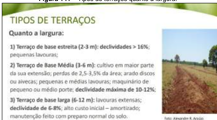
Figura 141 – Tipos de terraços quanto à largura.
