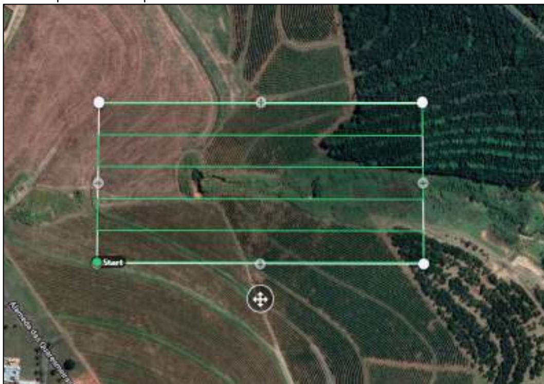
Figura 95 – Representação do plano de voo usado no levantamento aerofotogramétrico. As linhas em verde correspondem ao percurso feito pelo drone.
