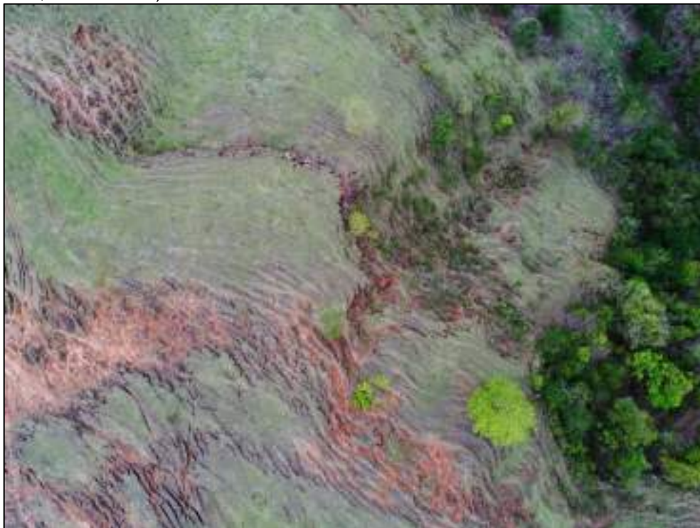
Figura 157 – Feições erosivas paralelas às curvas de nível, na forma de trilhas, em área de pastagem (Foto tirada com drone, em 07/10/21).
