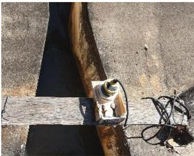
Figura 4.2.21 – Medidor ultrassônico que registra a vazão afluente
