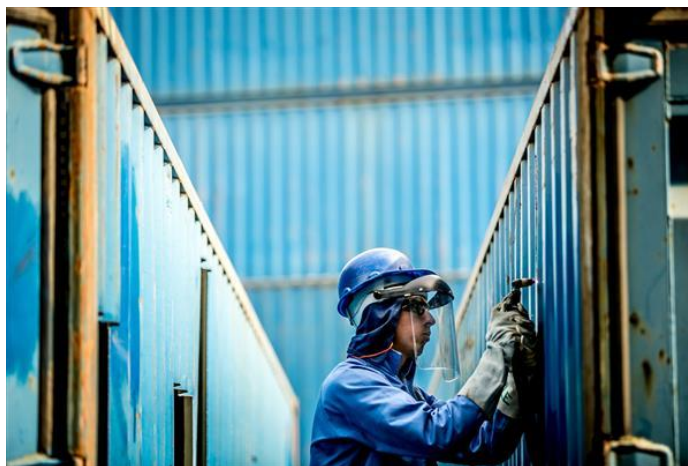
Figura 17 – Corte executando a plasma
