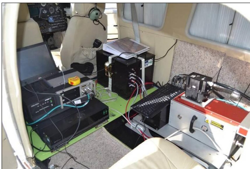
Figura 5 – Sistema de Aerolevantamento – SAAPI.
