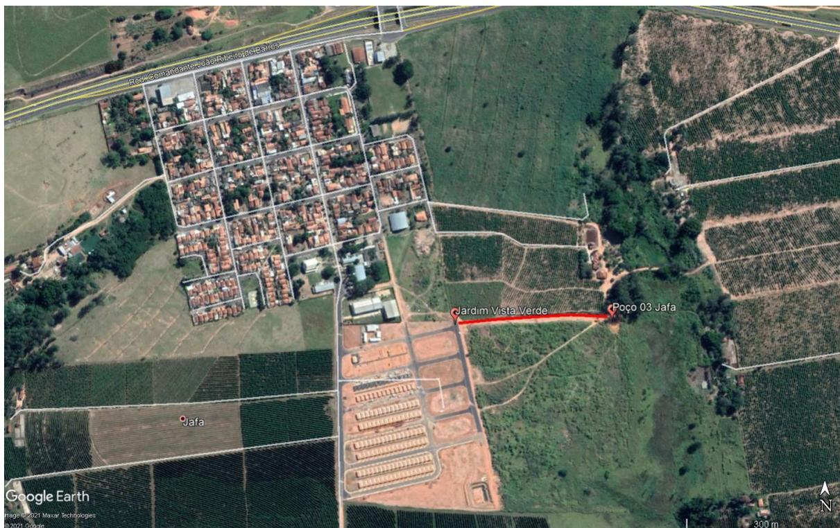
Imagem 1: Croqui do traçado da rede elétrica do Jardim vista verde até o Poço 03 de Jafa (Imagem retirada do Google Earth).
